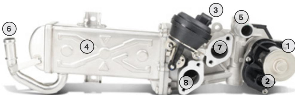
Il ricircolo E.G.R. (Exhaust Gas Recirculation) viene utilizzato sui motori per ridurre le emissioni di ossidi di azoto (NOx). Sebbene l'azoto sia considerato un gas inerte a temperatura ambiente, alle altissime pressioni e temperature raggiunte nella camera di combustione, forma molecole di NOx: questi gas sono una fonte di inquinamento da ridurre per rientrare negli Standard europei sulle emissioni inquinanti.
