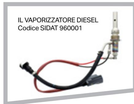
Il vaporizzatore è formato da un serbatoio di piccole dimensioni in cui il combustibile iniettato evapora. Subito dopo, attraverso un diffusore, i vapori passano nel condotto di scarico e questo sistema permette di ridurre le dimensioni del filtro anti-
