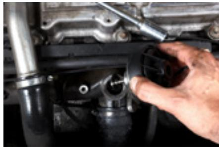
permanente. Le conseguenze sono un'andatura non fluida del propulsore, un minimo non uniforme o scarsità di potenza. Le cause di un'aria di aspirazione o di sovralimentazione con elevato contenuto di olio possono essere ricondotte a diversi fattori: guasti nello sfiato del monoblocco, cuscinetti usu-
