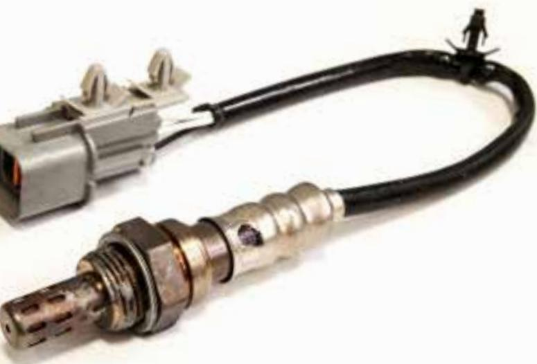
Per concludere, è necessario effettuare le opportune verifiche su catalizzatore, motore e valvole per appurare eventuali irregolarità e, in caso di un funzionamento scorretto, sostituire la Sonda Lambda con il componente adeguato.
