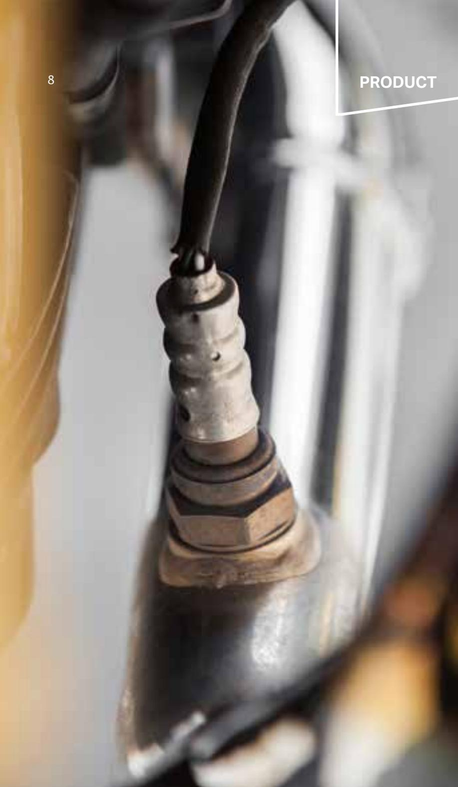
La Sonda Lambda, nota anche con il nome di sensore ossigeno, è un componente fondamentale in quanto è impiegato per "informare" l'unità di controllo motore circa la quantità d'ossigeno presente nei gas di scarico.
