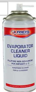
**USO 17.1027:** Agitare la bombola prima dell'uso, spruzzare il prodotto nella presa d'aria dietro la sede del filtro, precedentemente rimosso, con le bocchette aperte e la modalità ricircolo interno alla velocità massima.
